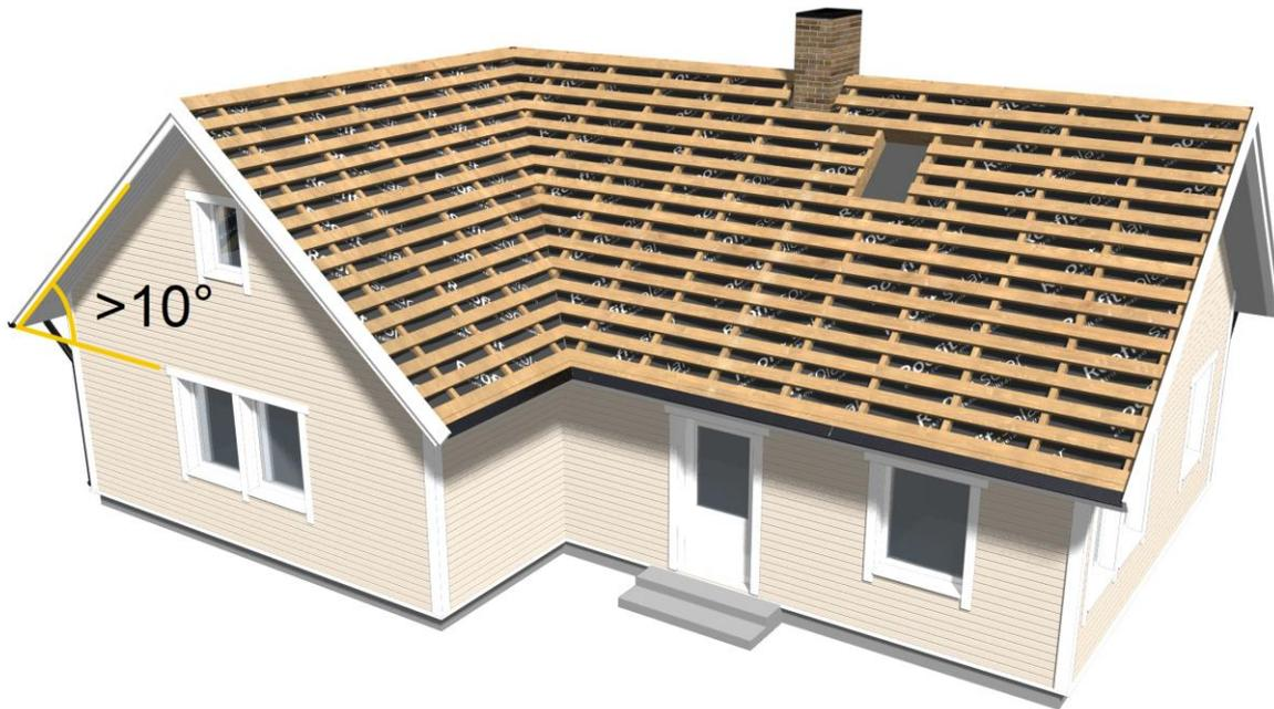
Der minimal und maximal zulässige Lattenabstand von Mitte zu Mitte beträgt 200mm bzw. 400mm. Die Best Practices von Roofit.Solar empfiehlt einen Traglattenabstand von min. Abstand von 200mm, um eine ausreichende Kühlung und Windwiderstand sicherzustellen.
