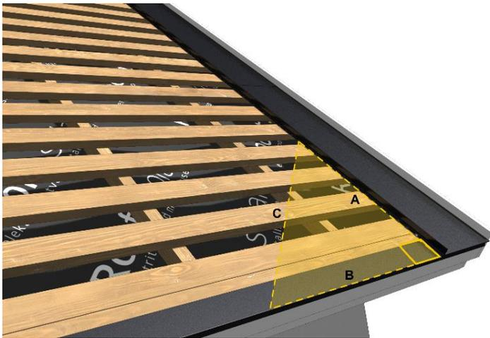
Wenn Sie den empfohlenen Lattenabstand von 200 mm einhalten, benötigen Sie sowohl beim PV-Modul als auch beim Passivmetall 1 Schraube für jede zweite Dachlatte im mittleren Teil des Daches und 1 Schraube für jede Dachlatte an den Rändern. Mindestens 200 mm von der Unterkante des Daches entfernt sollte eine vollständige Verschalung vorhanden sein, und es müssen zusätzliche Schrauben verwendet werden, um die ordnungsgemäße Befestigung des Metalls sicherzustellen.
