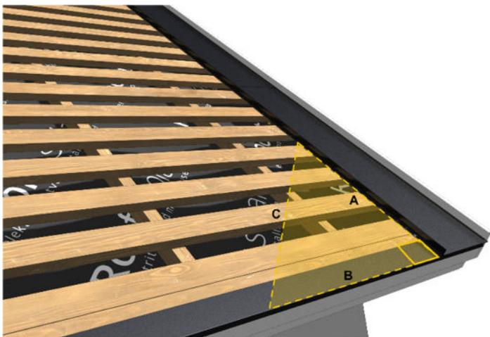
Wenn Sie den empfohlenen Lattenabstand von 200 mm einhalten, benötigen Sie sowohl beim PV-Modul als auch beim Passivmetall 1 Schraube für jede zweite Dachlatte im mittleren Teil des Daches und 1 Schraube für jede Dachlatte an den Rändern. Mindestens 200 mm von der Unterkante des Daches entfernt sollte eine vollständige Verschalung vorhanden sein, und es müssen zusätzliche Schrauben verwendet werden, um die ordnungsgemäße Befestigung des Metalls sicherzustellen.
