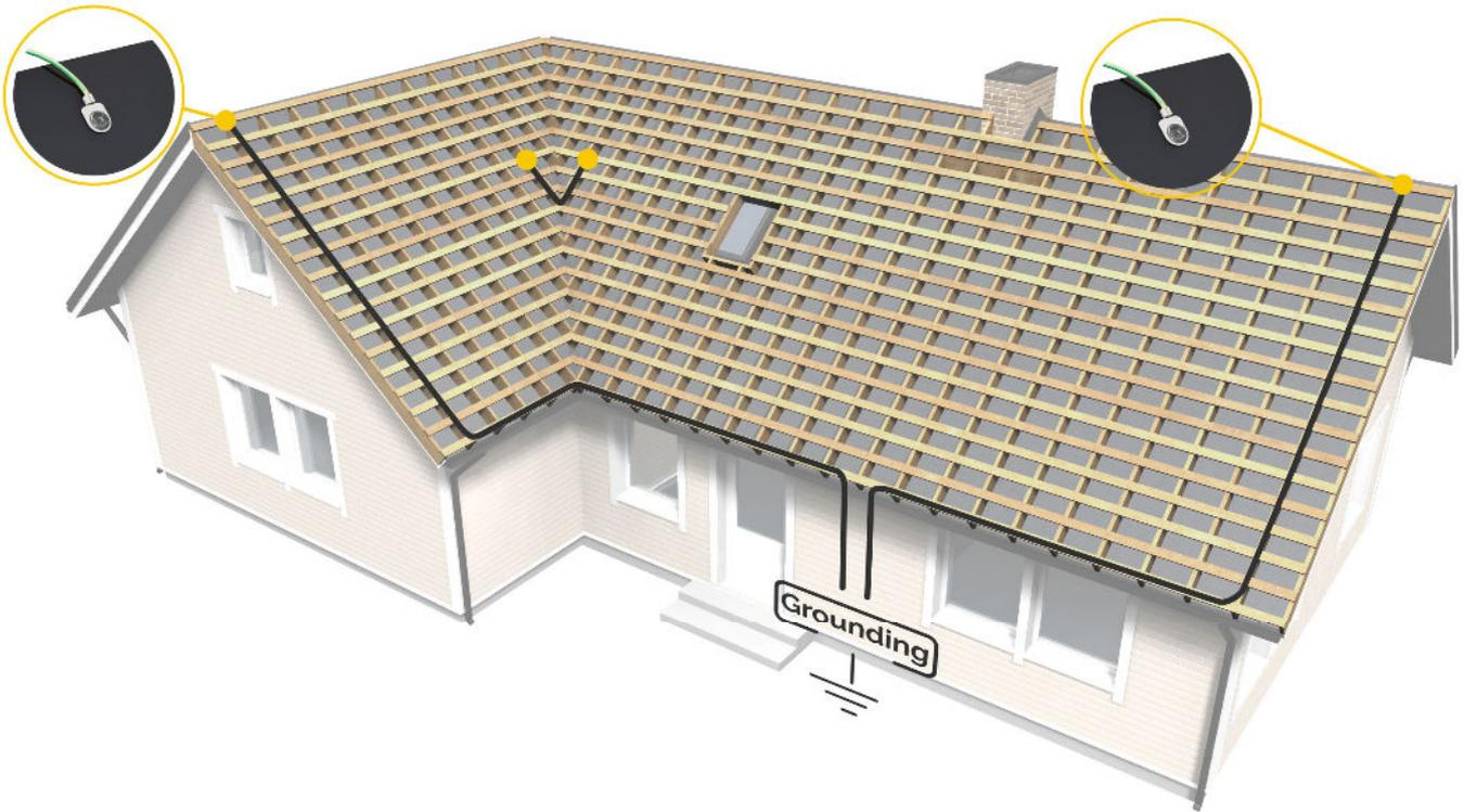
Jede PV-Anlage muss an das Erdungskabel angeschlossen werden, um die elektrische Sicherheit zu gewährleisten. Alle Roofit.Solar Produkte, die miteinander gefalzt werden, sind galvanisch verbunden. Roofit.Solar empfiehlt 2 Erdungskabel pro Dach, um die Möglichkeit zu bieten, die Erdungsqualität zu messen.
