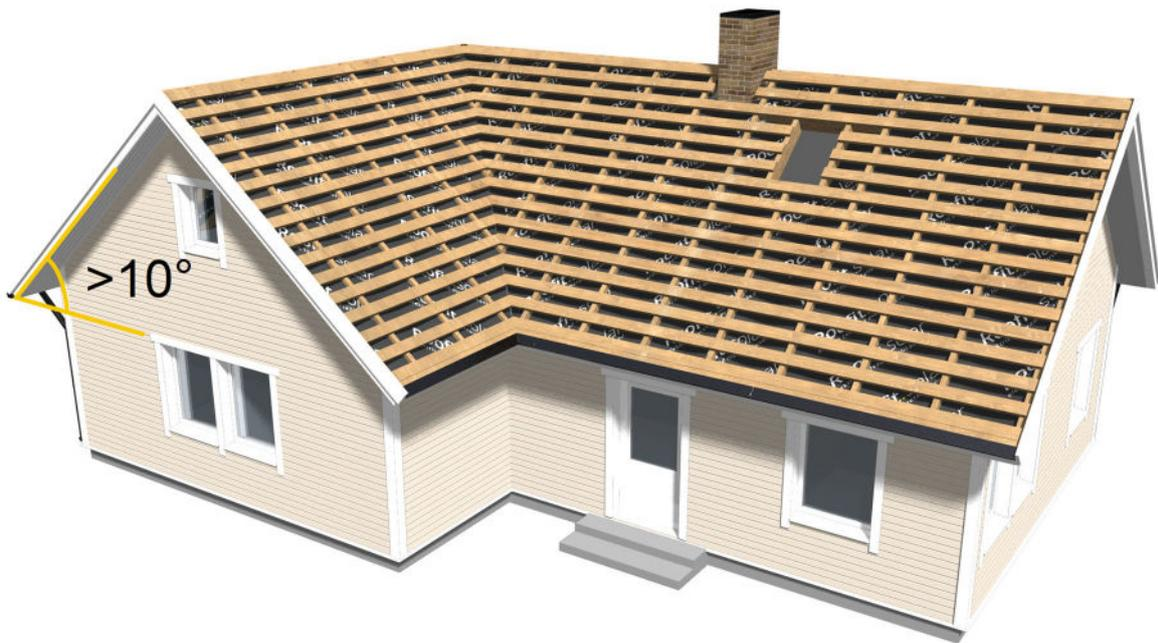
Für die Montage der Traglattung verwenden Sie Holzlatten mit den Maßen 32mm x 100mm. Der minimal und maximal zulässige Lattenabstand von Mitte zu Mitte beträgt 200mm bzw. 400mm. Die Best Practices von Roofit.Solar empfiehlt einen Traglattenabstand von min. Abstand von 200mm, um eine ausreichende Kühlung und Windwiderstand sicherzustellen.
